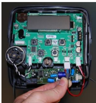
DAS KABEL DES CHLOR-GENERATORS ANSCHLIESSEN, WIE IN DER ABBILDUNG DARGESTELLT
