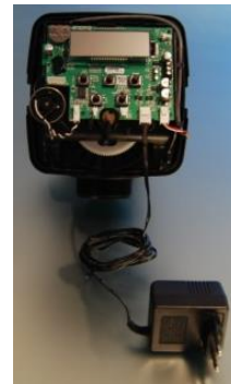
STANDARDANSCHLUSS DES NETZTEILS OHNE CHLOR-GENERATOR
