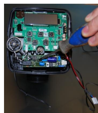
DAS KABEL DURCH DEN ENTSPRECHENDEN STECKPLATZ VERLEGEN
