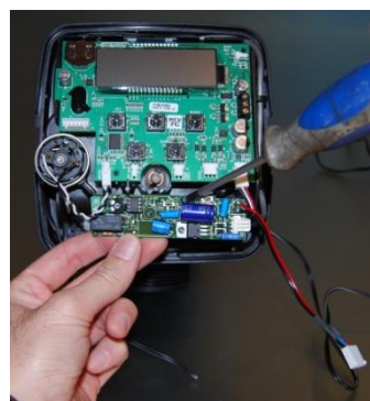
DIE LEITERPLATTE DES CHLOR-GENERATORS MIT DEN ZWEI MITGELIEFERTEN SCHRAUBEN BEFESTIGEN
